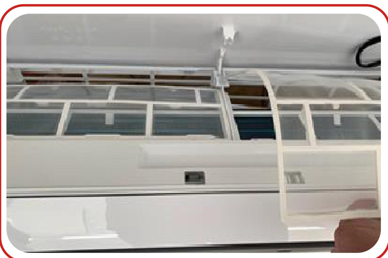
Mantenga el equipo desconectado de la corriente. Retire el filtro de aire de la parte delantera de la unidad de A/C. Los filtros reducen la potencia de refrigeración y aumentan las posibilidades de formación de hielo.
