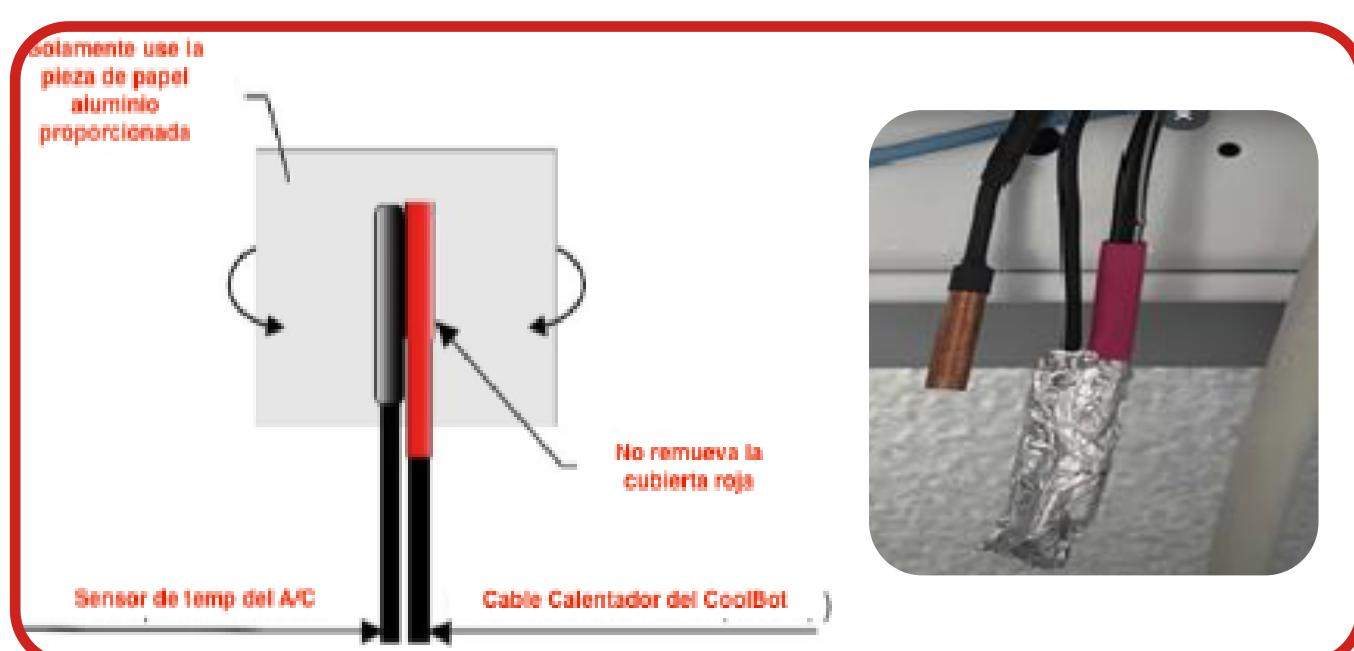
Usando SOLAMENTE una pieza cuadrada de papel aluminio de 3x3 cm, coloque el cable del calentador CoolBot (punta roja) junto al sensor de temperatura del aire acondicionado (sensor primario).
